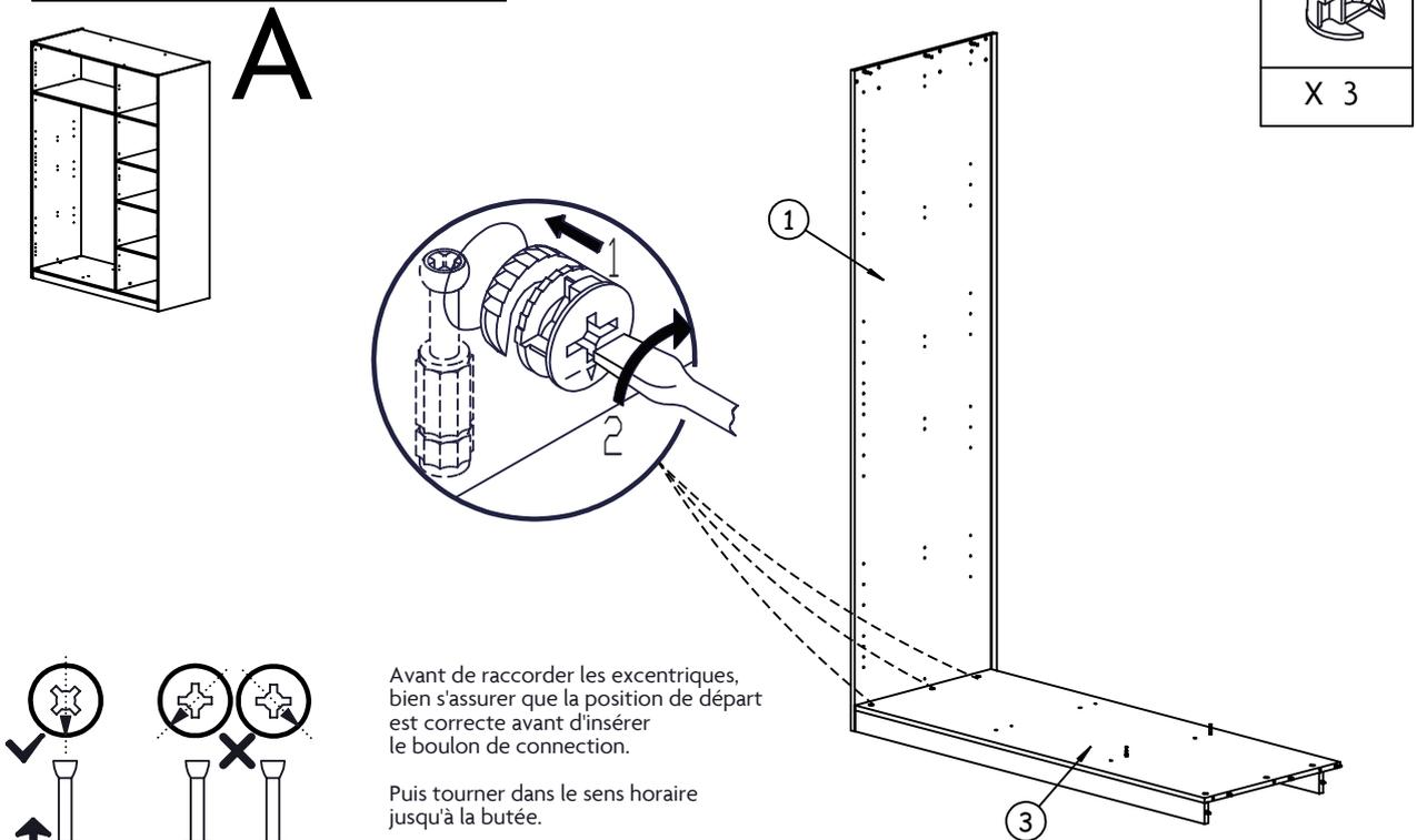
Avant de raccorder les excentriques, bien s'assurer que la position de départ est correcte avant d'insérer le boulon de connection.
