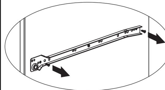
Entfernen sie die vordere und die hintere Schraube an der Schubladenführungsschiene komplett. Nicht die mittlere. Die mittlere Schraube etwas lösen, aber nicht entfernen.
