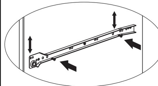
Befestigen Sie die Schiene mit den Schrauben erneut an den Langlochbohrungen, ziehen sie diese aber noch nicht ganz fest. Richten sie nun die Schiene nach Bedarf aus und ziehen Sie die Schrauben fest an.
