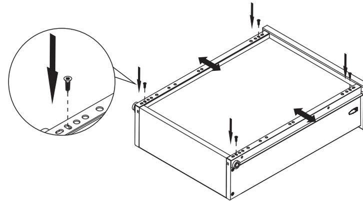
Verwenden Sie nun für die Zentralschraube (Schiene Mitte) das freie, nicht vorgebohrte Loch für die dritte Befestigung und ist vollbracht!
