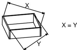
**Bitte beachten! Den Boden der Schublade wird festgenagelt, nach der Bestimmung der Diagonal zwischen den Elementen (siehe Abbildung).**
